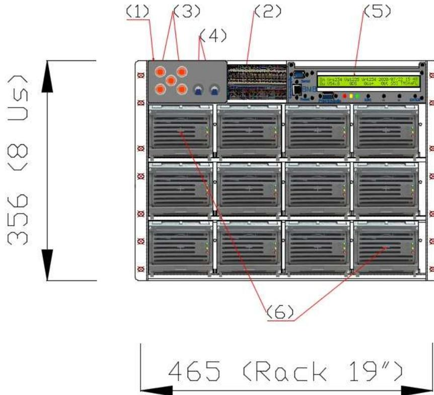
(1) Conectores e Bornes de Interligação Teto (Acesso p/ Parte Superior) para:
