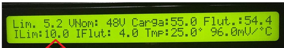
Limite de corrente liberada pelo PLC, em fase de carga, para cada uma das 4 posições eletricas ativas.
