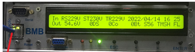
Conexão via Placa de Comunicação WIZ107SR-RS232
